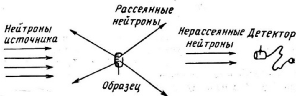
Рис. 2.1. Прохождение нейтронов через мишень
